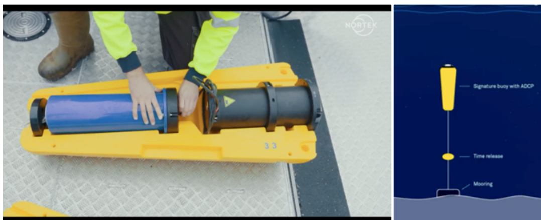
Figura 66 - A sinistra il sensore ADCP (in nero) all'interno della boa di spinta con il suo pacco batterie (blu); a destra lo schema di installazione dello strumento sul fondale marino.
